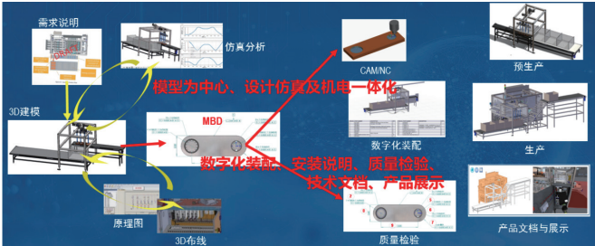
(图 8: MBD 模型数据贯穿整个产品开发流程)
